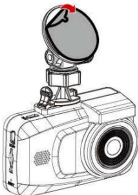
3. フロントガラスにブラケットを配置し、しっかりと押し付けます。ベース部が所定の位置に確実に固定されていることを確認してください。
