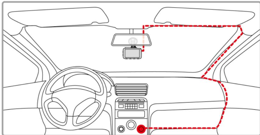
1. 本体の電源コード接続端子にカーアダプターの一方向の端を接続します。入力：DC 5V / 1A
